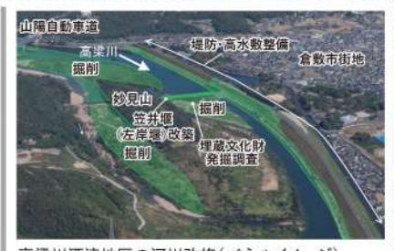
高梁川酒津地区の河川改修(パネルイメージ)
